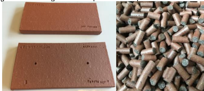
Figure 1. Exemples de matériaux STEMPHOS sous la forme cylindrique (1,5 x 4 cm) et sous forme de plaquette (17 x 7,5 x 1,5 cm).
