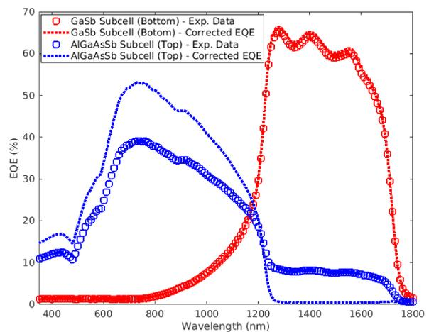
Figure 2: EQE de la cellule tandem AlGaAsSb/GaSb (Exp. Data et EQE corrigées)
